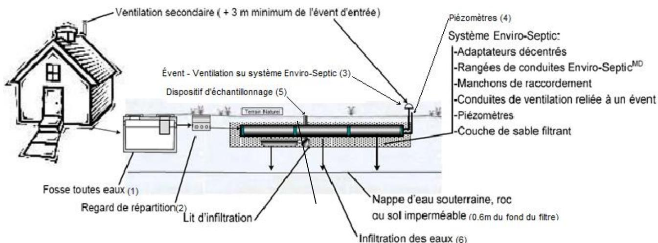
Figure 10 – Schéma du dispositif de traitement Enviro-Septic<sup>MD</sup> non étanche
